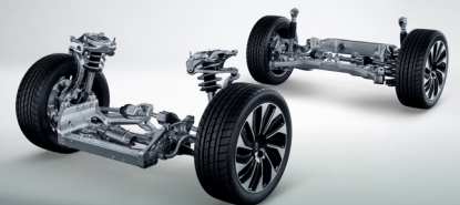
سیستم تعلیق جناقی دوبل چهار اتصالی کمبر متغیر
